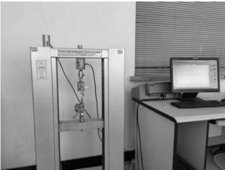
图 6 金属化膜抗拉强度试验 Fig. 6 Tensile strength test of metallized film
